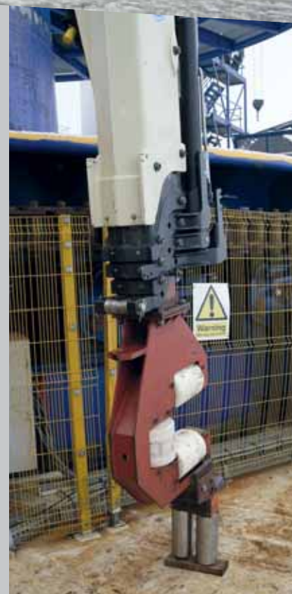
Stilstudie av stödrollar på en kran som används vid lastning av kabel.
